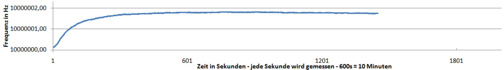
Als Vorbereitung auf die vierte Messung habe ich am Ende der letzten Messung die Frequenz im VNWA auf genau 10 MHz eingestellt. Je länger der TCXO arbeitet, umso besser wird er. Diese Genauigkeit ist jetzt so hoch, dass der VNWA im normalen Funkalltag als veränderliches „Frequenznormal“ verwendet werden kann. (Soweit ein TCXO ein Normal sein kann ;-)).
