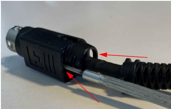
Auf beiden Seiten je mit einem kleinen Schraubenzieher den Kunststoff nach außen drücken und das Gehäuse nach vorne ausschieben
