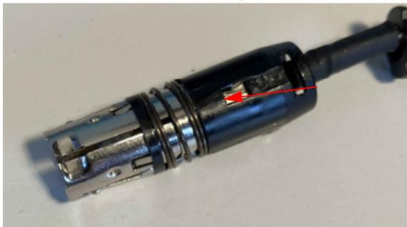
Schwarzes Kunststoffteil leicht nach links schieben, dabei die Nase auf der linken Seite leicht nach innen drücken (siehe Pfeil). Das Gehäuse kann dann nach rechts weggeschoben werden, die Metallschalen zerfallen in zwei Teile, die Feder geht ebenfalls Richtung Kabel weg
