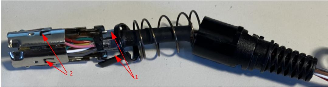
1. Mit einer Spitzzange die Zugentlastung hinten quer zusammenpressen und Pressring entfernen
