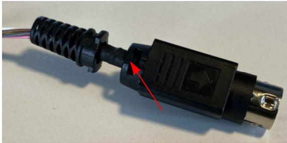
mit einem Kleinen Schraubendreher die Laschen auf beiden Seiten vorsichtig anheben und Kabelschutztülle nach hinten wegziehen.
