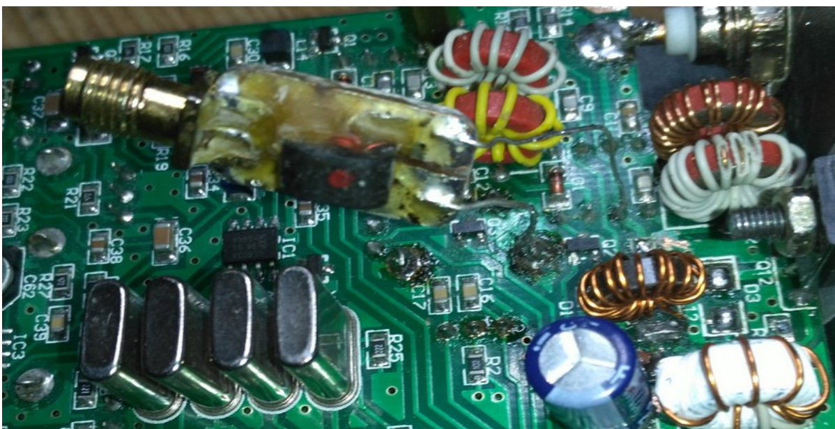
Bild 5 : Einkopplung mit 50 zu 19 Trafo.
