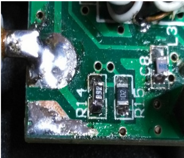
Bild 24 : Eine weitere kleine Änderung . Der Spannungsteiler zur Messung der Ausgangsleistung. R14 ändern von 2k2 auf 3k9. Der Atmega könnte ansonsten zu viel Spannung bekommen an seinem Messeingang. Einen defekten Atmega können wir nicht gebrauchen, also lieber besser gleich ändern, sicher ist sicher.
