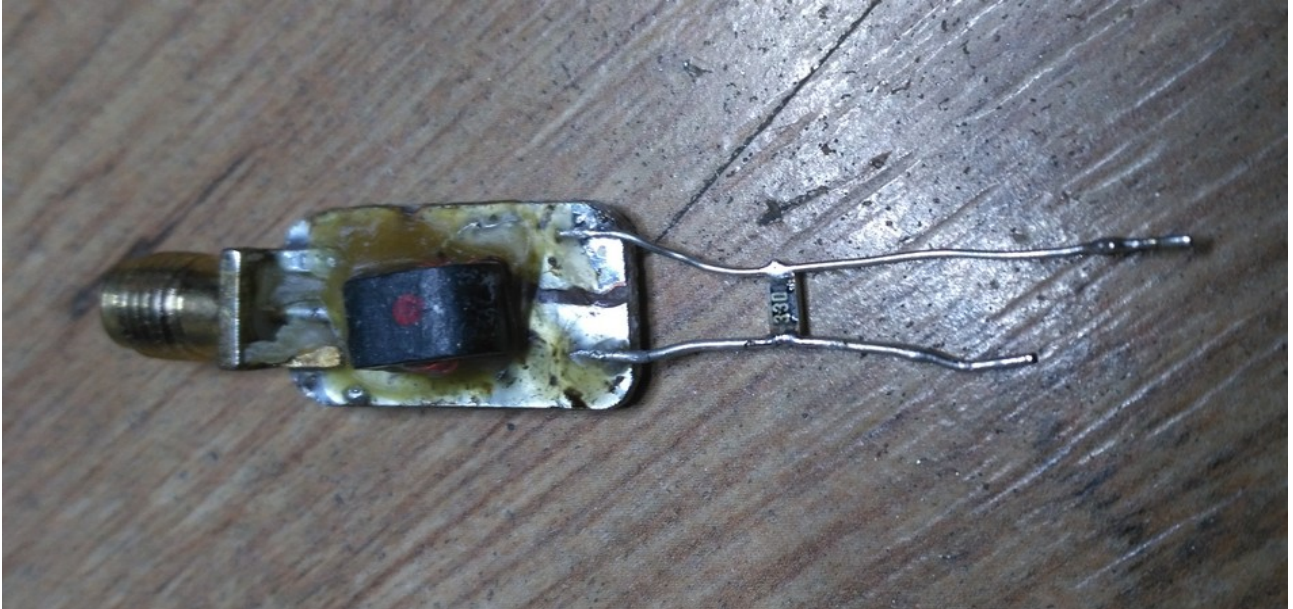
Bild 2 : eingefügter 33 Ohm Widerstand für die Kalibrierung meines NWT502
