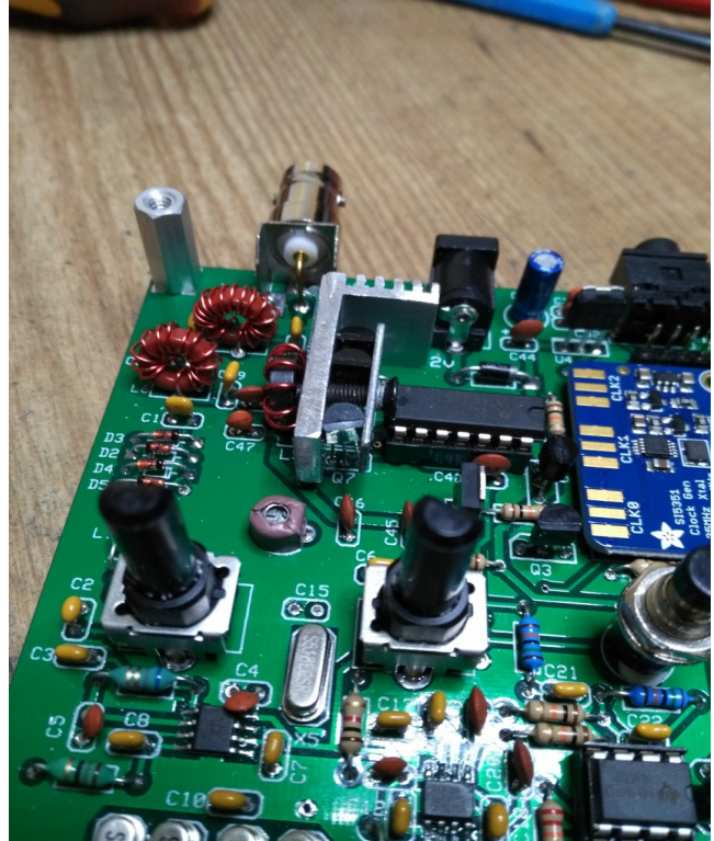
Bild 39: KK angeschraubt und Die Befestigungsschraube musste noch mal ausgetauscht werden, sie ragte zu viel durch den Kühlkörper in Richtung L5 hindurch. Der sichere Abstand soll doch gewahrt bleiben.
