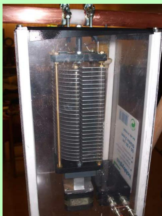
Bei einer Induktivität von 4,5  $\mu$ H wird bei der untersten Bandfrequenz von 3,5 MHz ein C von 457 pF, bei der obersten Bandfrequenz von 7,1 MHz von 112 pF benötigt. Zur Verfügung stand ein 2 kV-Lanley-Drehkondensator mit einem Abstimmbereich von 15 bis 370 pF, dem im 80-m-Band ein hochspannungsfester Festkondensator von 200 pF parallel geschaltet wird. Beim Betrieb mit 75 W treten am Drehkondensator keine Hochspannungsüberschläge auf.
