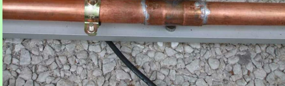
An einem der beiden Fittings wird an die 15-mm-Öffnung eine Metallplatte mit einer PL-Buchse für die Einspeisung angelötet.
