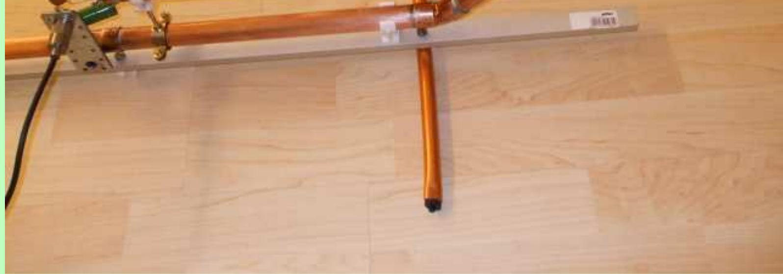
Für die Einspeisung wurde eine Gamma-Match-Anordnung auf einem Seitenarm des Achtecks gewählt, da dies mechanisch am leichtesten realisierbar und stabil ist.
