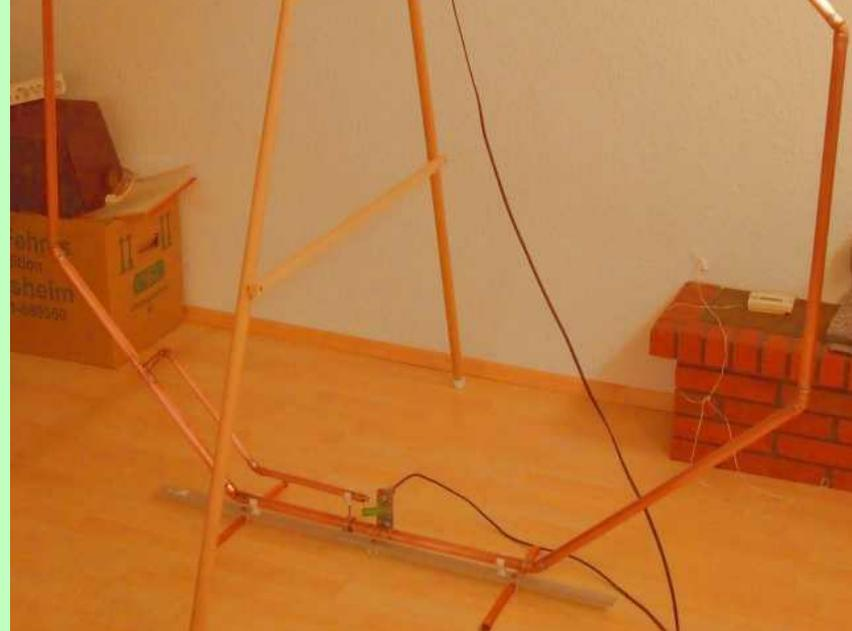
Nach dem Aufbau und ersten Tests werden die Kupferrohrteile mit Schleifpapier gereinigt und zum Wetterschutz mit einem klaren Acryl-Autolack eingesprüht. Dies ist bei Außenbetrieb zwingend notwendig, weil an den Übergängen zwischen Lötzinn und Kupferrohr erfahrungsgemäß das Kupfer rasch korrodiert und insbesondere an Stellen mit stehenden Wassertropfen Kupferoxid-Hydrat ausblüht.
