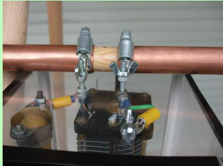
Der Anschluss des Drehkos erfolgt mit zwei Schraubsschellen, an die Kabelschuhe zur Befestigung angelötet sind.
