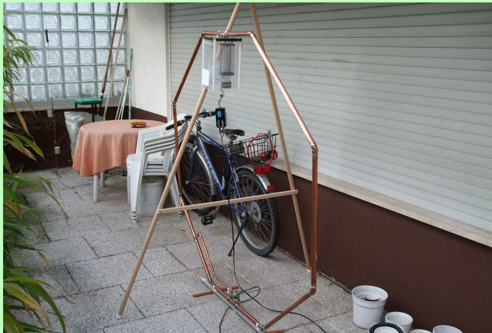
Das oberste Teilstück des Achtecks wird ebenfalls mittig getrennt, mit einem locker eingesteckten 20 mm dicken Holz-(Besenstiel-Teil) oder Plastikteil zusammengesteckt, so dass ein Abstand von ca. 2 cm verbleibt. Dieses und die restlichen Teilstücke werden zum Achteck zusammengelötet.
