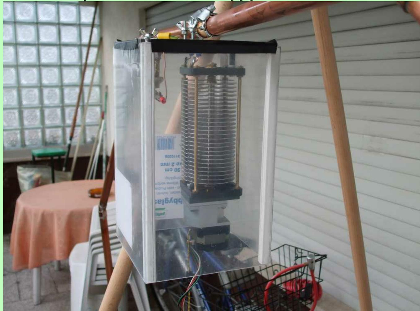
Der Drehko ist in ein Gehäuse aus Plexiglas eingebaut, das auch den Parallelkondensator und die Schrittmotorsteuerung beherbergt. Die Anschlüsse des Parallelkondensators und die Befestigung am Rohr erfolgt mit Flügelschrauben, um die Anschlüsse flexibel zu handhaben.
