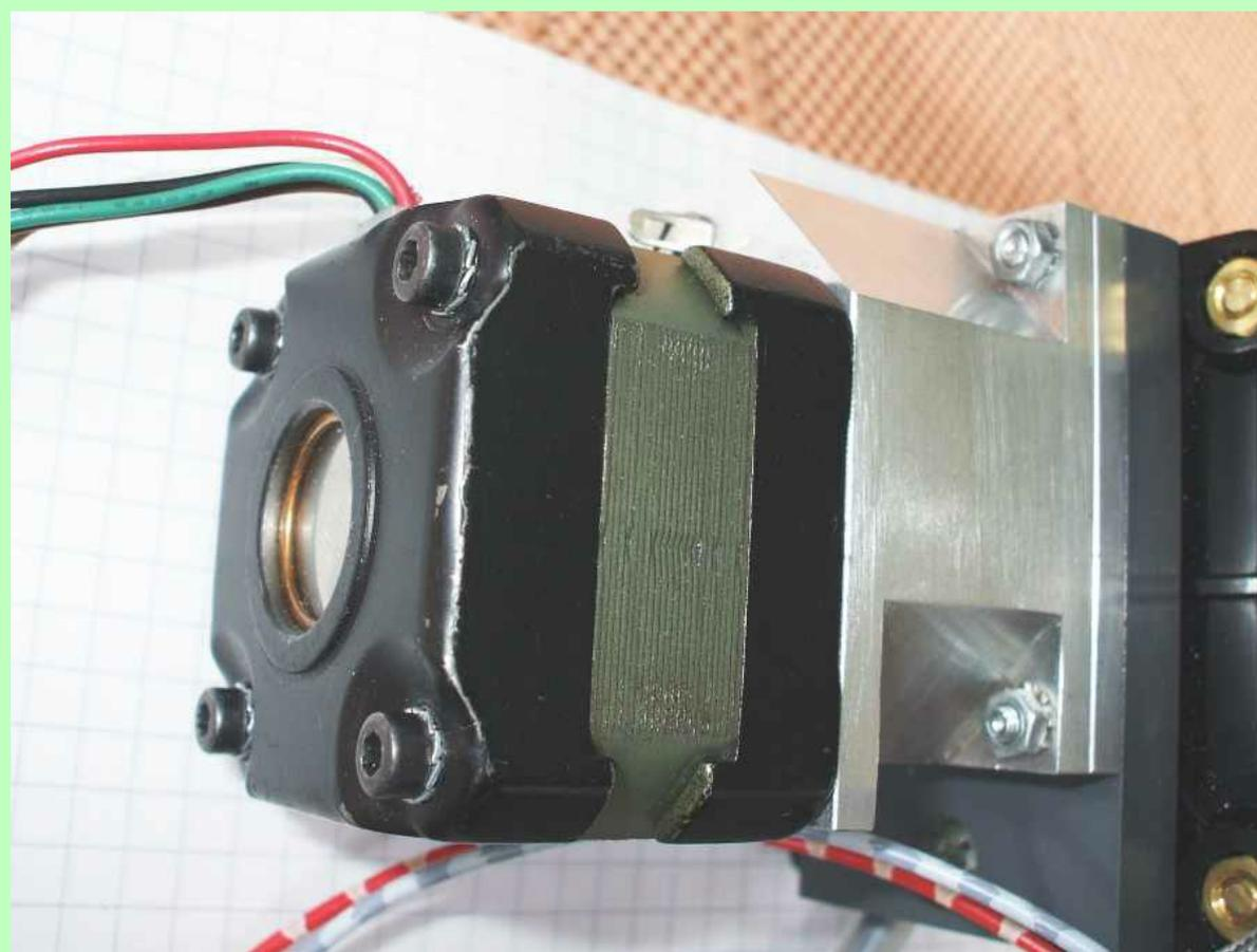
An den Drehko ist über ein Getriebe ein Schrittmotor angeflanscht. Das Getriebe ist so ausgelegt, dass der Schrittmotor etwa 1000 Schritte benötigt, um den gesamten Einstellbereich des Drehkos zu überstreichen. Die Einstellung der Anzahl Schritte und die Hardware der Ansteuerung ist hier beschrieben: [Steppermotorsteuerung mit einem ATMEL ATtiny13](#)
