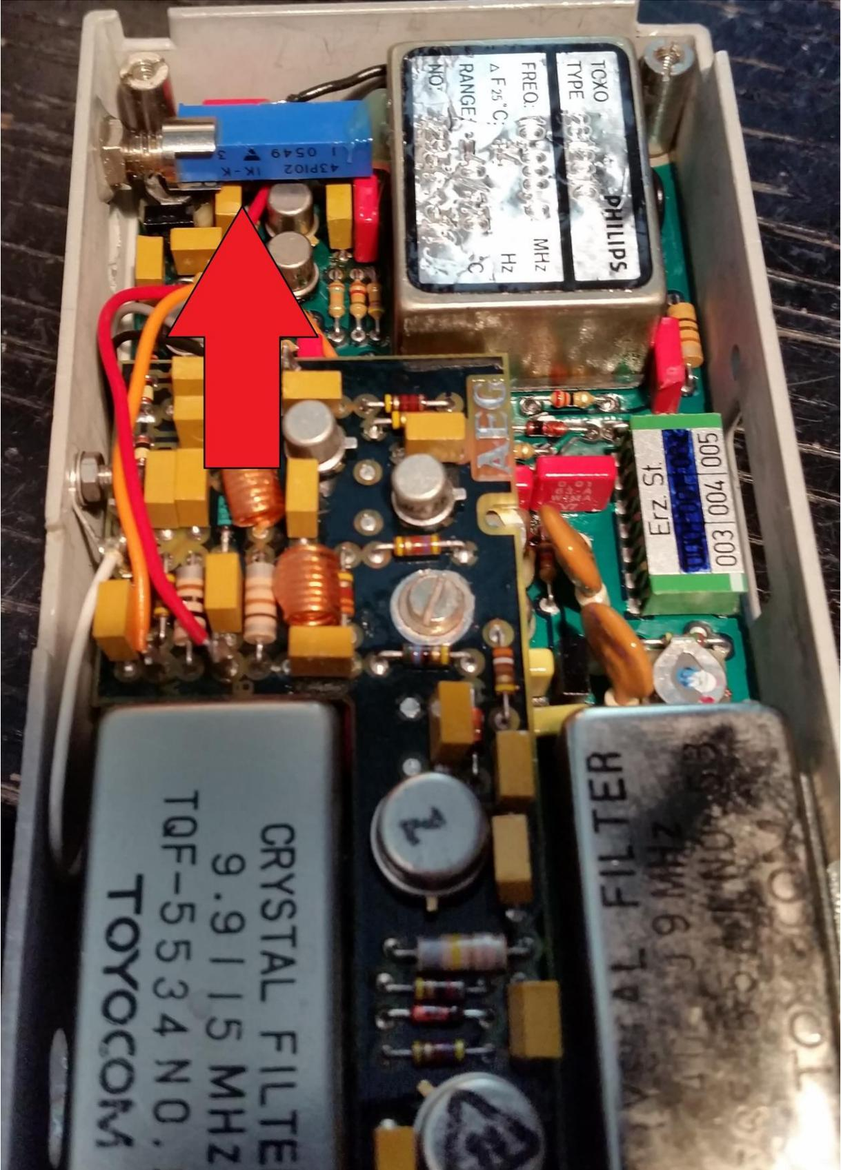
Der Einbauplatz beim Cathoden TCXO ist sehr begrenzt, es muss der Befestigungsbolzen weggelassen werden, durch Mutter M2,5 ersetzen und im Kassettendeckel den Schraubeinsatz entfernen (leider eine massive Änderung).
