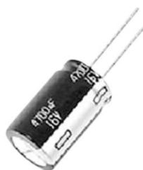
Dieser Elko hat eine Kapazität von 4700 $\mu\text{F}$  bei einer maximalen Betriebsspannung von 16V. Der Minuspol ist durch Aufdruck und das kürzere Anschlussbeinchen gekennzeichnet.
