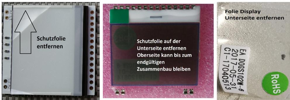
[ ] Das Display mit seinen Beinchen durch die korrespondierenden Lötungen des Beleuchtungskörpers stecken, danach dann durch die passenden Lötungen der Leiterplatte.
