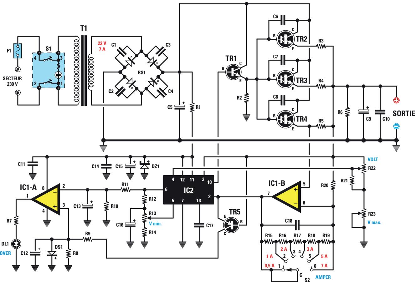
Figure 4: Schéma électrique de l'alimentation stabilisée variable protégée en courant. S2 permet de choisir la valeur maximale de courant que nous voulons prélever en sortie. Si la valeur est dépassée, DL1 s'allume et la tension de sortie s'abaisse.
