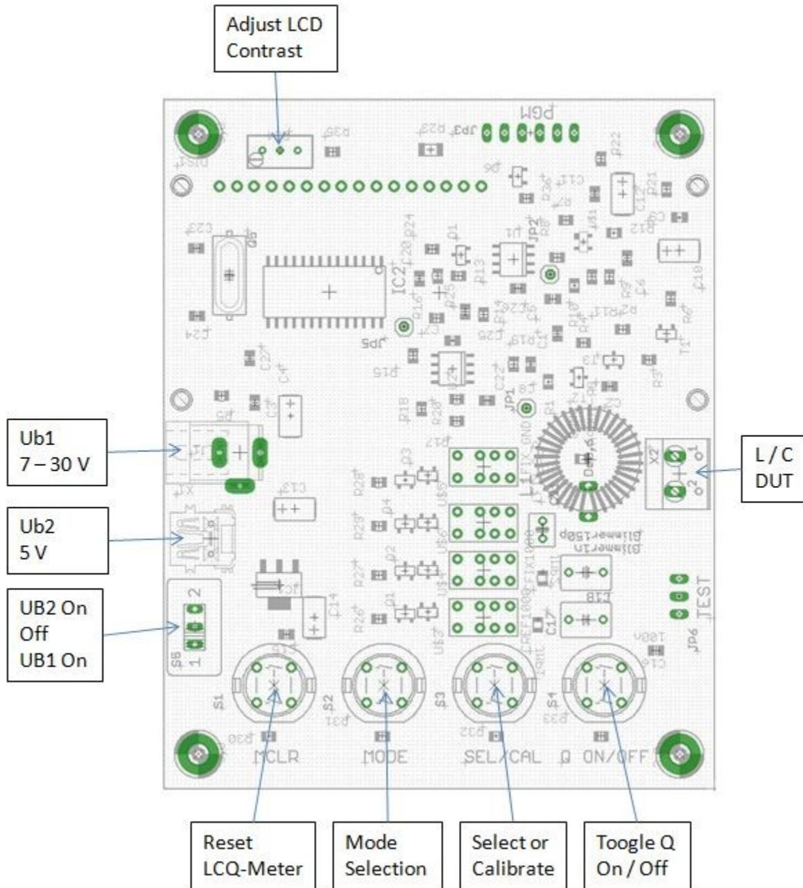
Das Bild zeigt die Bedienungs- und Anschluelemente des LCQ-Meters:
