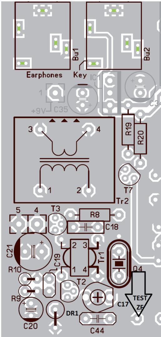
Der Kondensator C44 kann je nach Beschaffungslage in zwei verschiedenen Bauformen im Bausatz enthalten sein, der Wert ist in jedem Fall 220pF. Es ist entweder ein NPO Vielschicht-Kondensator. Dessen Aussehen kennen wir schon, dieser Typ wurde gleich am Anfang in BG1 eingebaut. Es könnte aber auch ein Styroflex Kondensator sein. Diese sehen aus, wie eine kleine, dünne Rolle aus silbrigem Papier mit Plastiküberzug.
